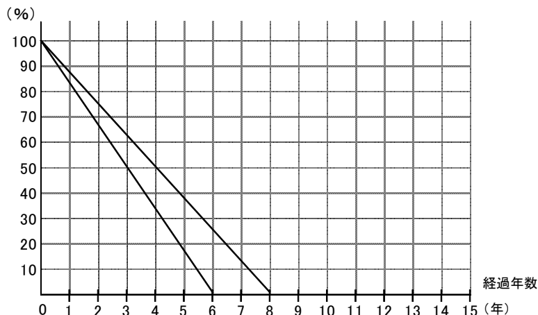
設備等の経過年数と借主負担割合（耐用年数6年及び8年、定額法の場合） 借主負担割合（原状回復義務がある場合）
